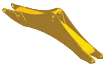
Las grandes estructuras de la sección de la caja, con fabricación, fundición y forjado gruesos de múltiples placas se utilizan en zonas de alto estrés como la punta de la pluma, la base de la pluma, el cilindro de la pluma y el pie de fijación para mejorar la durabilidad.
